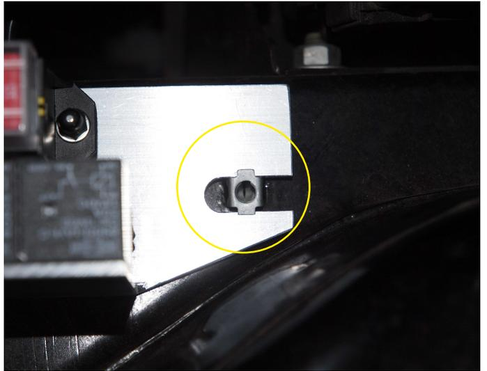
Den Kabelstrang zur Stromversorgung richtung Batteriepol, die beiden Kabelstränge für die Lampen richtung Fahrzeugfront ausrichten.
