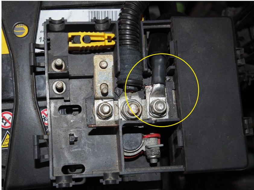
Für den Anschluß am Pluspol der Batterie bieten sich mehrere Möglichkeiten. Je nach Ausführung des Anschlußterminals stehen verschiedene Klemmschrauben zur Verfügung.
