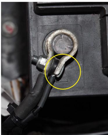
Der Masseanschluß kann an der Batterie oder an einer geeigneter Stelle der Karosserie angeschlossen werden.
